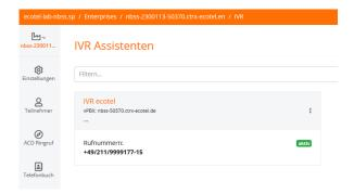
Zum Konfigurieren der IVR wird die Karte angeklickt. Man gelangt nun in ein Untermenü mit den Punkten »IVR Konfiguration«, »Rufnummern« und »Block Liste«.
